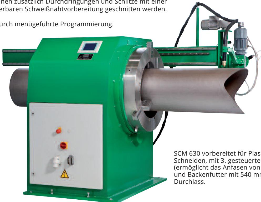
SCM 630 vorbereitet für Plasma Schneiden, mit 3. gesteuerter Achse (ermöglicht das Anfasen von Endschnitten) und Backenfutter mit 540 mm Durchlass.
